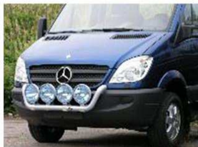
70 0668 Mercedes Sprinter (06-) Frontbøjle incl. 4 stk. lygtebeslag (Hella Rallye 3000 FF), samt 4 stk. trukne ledninger. Kr.
