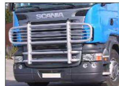
70 0115 "FRONTLINE" Frontbeskyttelse til Scania modellerne, P,R og T, Leveres med beslag til 2 stk. ekstralygter.
