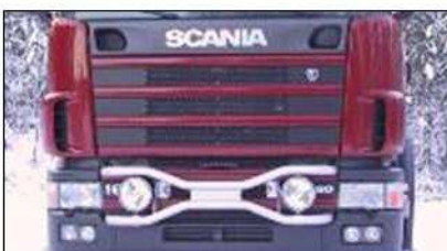
70 0162 "II LIGHT" Lygtebøjle til Scania model, P,R og T. Beslag og ledninger til 2 stk. lygter følger med.
