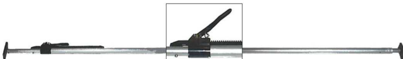
32 0453 Spærrestang med gummiklodser. Rør i aluminium, Ø42 mm. (Ø32 mm.). Spændes med tandstang, max. 170 kg. Længde 2350-2720 mm.
