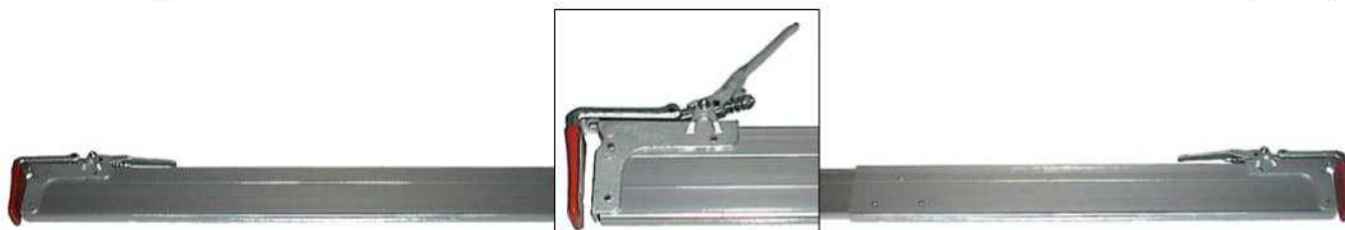
32 0451 Spærrestang med 2 galvaniserede justerbare låsegreb. Firkant rør i aluminium, 30 x 125 mm. (25 x 114 mm.). Længde 2400-2700 mm.
