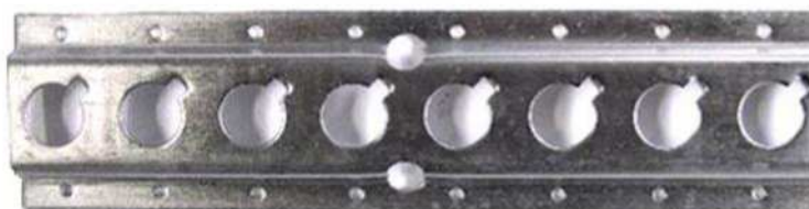
32 0525 Hulskinne galv., m/drænhuller. Monteringshuller Ø5 mm. c/c 41 mm.. lgd.3000 mm. 32 0550 Endestykke i grå plast til hulskinne.
