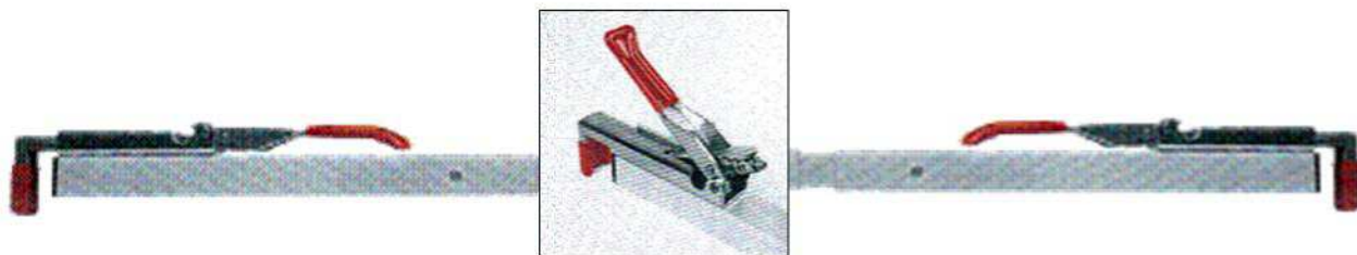
32 0450 Spærrestang med 2 galvaniserede justerbare låsegreb. Firkant rør 40x40 i aluminium, 40 x40 mm. Længde 1980– 2700 mm.
