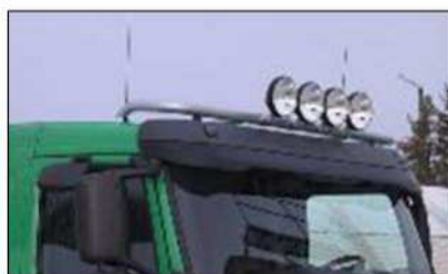
70 0226 "T-LIGHT L1/2H1" Taglygtebøjle til Volvo L1EH1- L2H1. Beslag til lygter skal bestilles separat.
