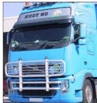
70 0215 "FRONTLINE" Frontbeskyttelse til Volvo FM/FH, version 2. Leveres med beslag til 2 stk. ekstralygter.
