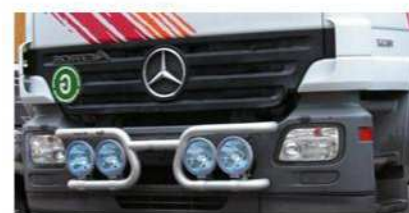
70 0464 "IV-LIGHT" Lygtebøjle til Mercedes Actros MP2. Beslag og ledninger til 4 stk. lygter følger med.
